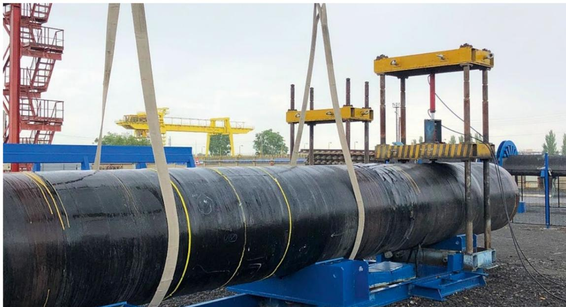
Механические испытания нового защитного покрытия
