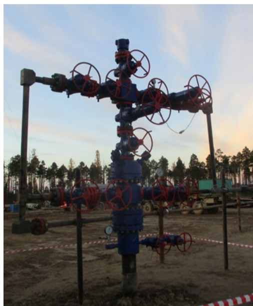
Фонтанная арматура на КТС № 83 № 2039 Чаяндинского НГКМ
