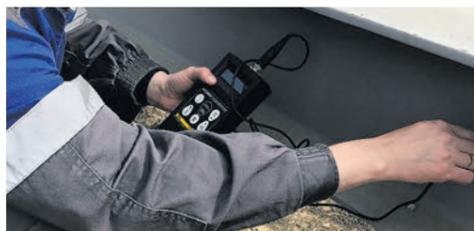
Магнитный толщиномер (проверка толщины нанесения лакокрасочного покрытия)
