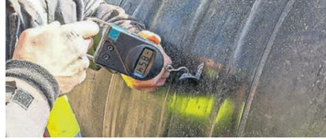
Адгезиметр (проверка адгезии изоляционного покрытия трубопровода)
