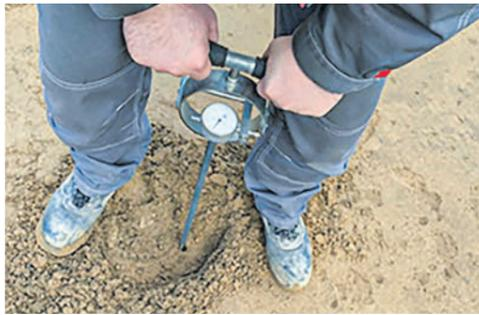
Пенетрометр (проверка качества уплотнения насыпного грунта)
