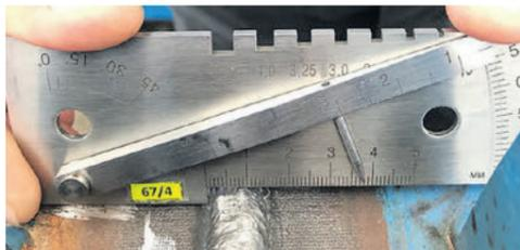
УШС-3 универсальный шаблон сварщика (проверка ширины сваренного шва)
