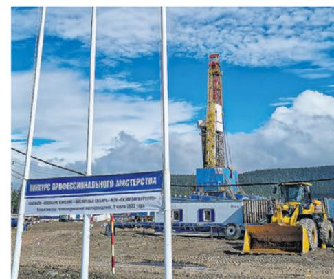
В настоящее время на Ковыктинском газоконденсатном месторождении работают 18 буровых установок, два флота ГРП (гидроразрыв пласта), пять установок с гибкой насосно-компрессорной трубой и семь подъемников.
